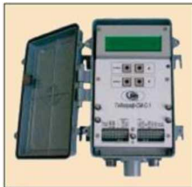
Рис. 2. Зона виявлення сейсмомодатчиків і блок оброблення сигналів засобу «Годограф-СМ-С1»
