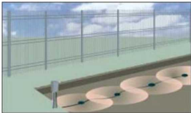
Рис. 2. Зона виявлення сейсмомодатчиків і блок оброблення сигналів засобу «Годограф-СМ-С1»
